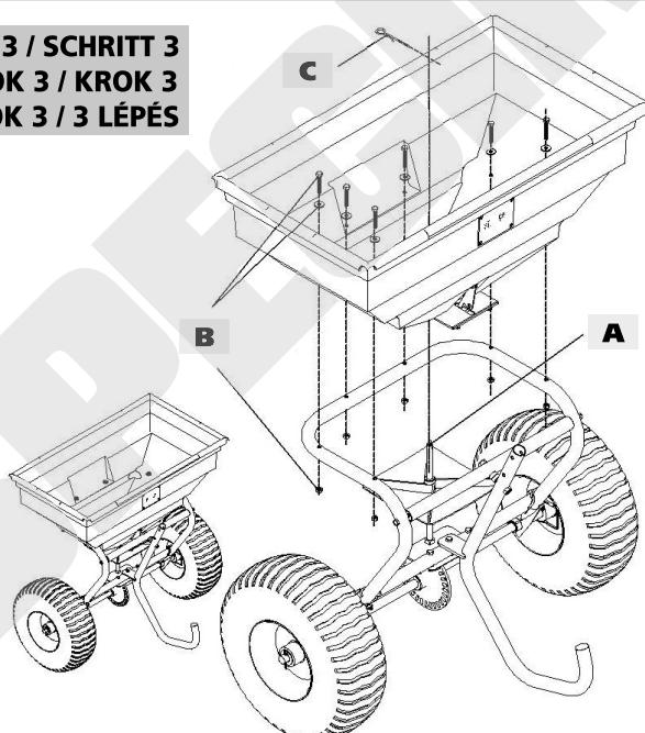
**STEP 3: Install the hopper / SCHRITT 3: Montage der Schütte / KROK 3: Montáž násypky /
